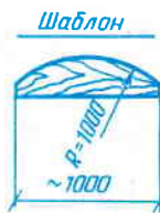
Рис. 3. Шаблон для выкладки сводчатой части погреба
